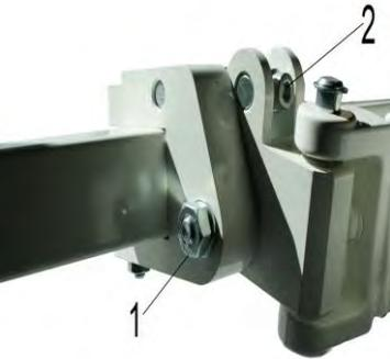
Die seitlichen Klemmschrauben (1) lösen – **nicht entfernen (Sechskantschlüssel SW 17)**. Markisen senken, Stellschraube (2) herausdrehen. Markise entlasten (anheben). Stellschraube hineindrehen. (Innensechskantschlüssel Nr. 6)
