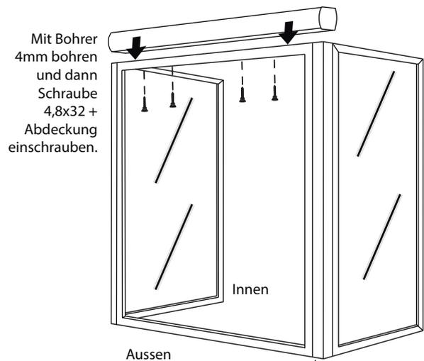
4. Wenn die Dachrinne an der Markise montiert ist, bohren und sichern Sie die unteren Schienen an den seitlichen festen Rahmen.
