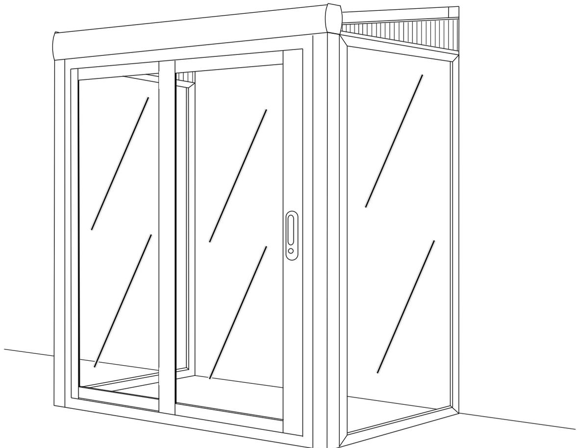
1. Bohren Sie den linken und rechten Rahmen gemäß dem untenstehenden Diagramm (für später siehe 3.) und stellen Sie sicher, dass der linke Rahmen mit dem breiten Teil heraus an der Schwelle befestigt ist und der rechte Rahmen mit dem breiten Teil hinein. Montieren Sie es dann durch Verschrauben der Seitenrahmen mit dem oberen Rahmen und der Schwelle.
