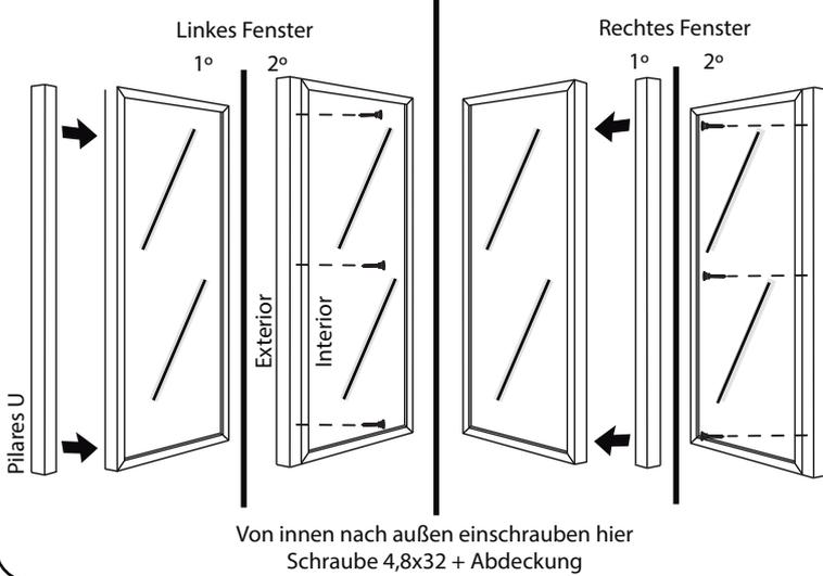
2B. Bohren Sie nun die Fenster mit einem 3,5 mm Bohrer und den Rahmen mit einem 6 mm Bohrer, damit sie aneinander befestigt werden können.
