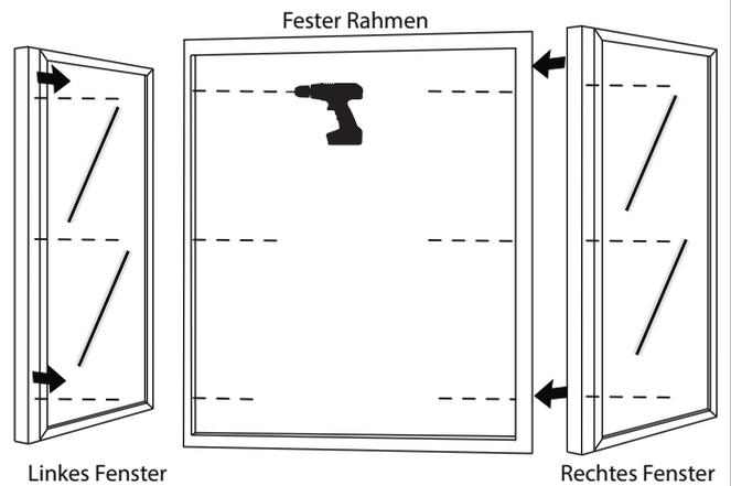
3. Schrauben Sie die festen Seitenfenster unter Berücksichtigung der zuvor perforierten Teile an den Blendrahmen (siehe 1.). Überprüfen Sie das Niveau der Markise.
