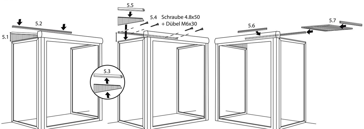
9. Setzen Sie nun die rechte Endabdeckung auf die Lamelle, um die zweite Polycarbonatplatte von der Abdeckung zu schieben.
