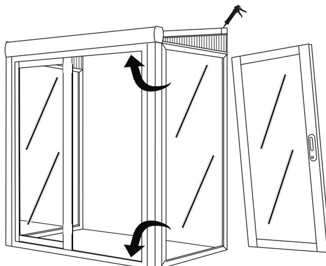
13. Die 4 Räder unter den Schiebern (ein Rad auf jeder Seite der Schieber) sind mit einem Inbusschlüssel verstellbar und bringen den Flügel in die geschlossene Position. Stellen Sie die Radbolzen wie unten gezeigt so ein, dass der Flügel parallel zum Pfosten steht. Führen Sie den gleichen Vorgang mit beiden Rädern beider Flügel durch. Bringen Sie für das Schloss den Vordermann mit dem Inbusschlüssel je nach Position des Schlosses in Position.
