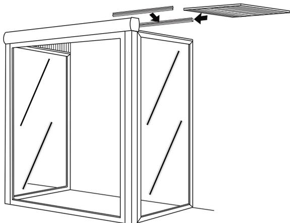
10. Platzieren Sie die Trapezplatte auf die rechte Seite und den oberen Balken.
