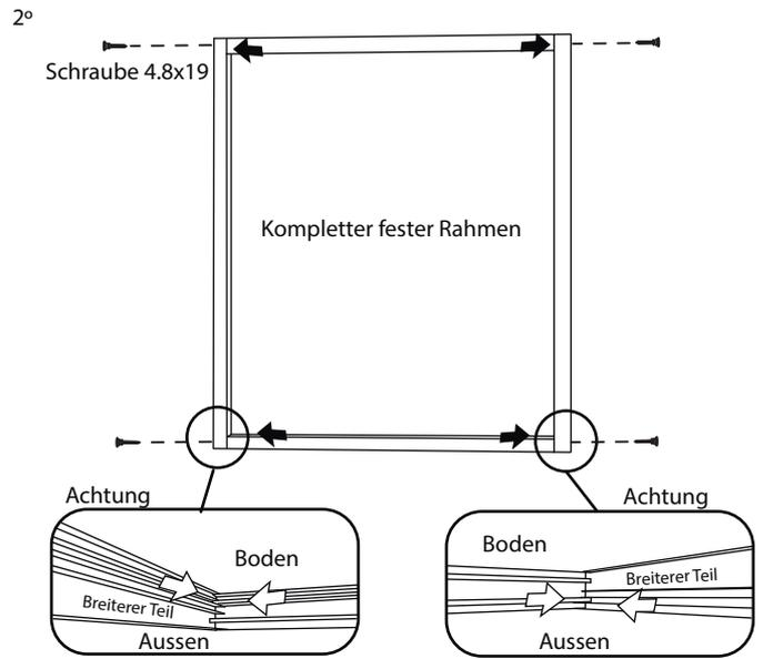
2A. Montieren Sie die U-Stützen an den festen Seitenscheiben durch Verschrauben.
