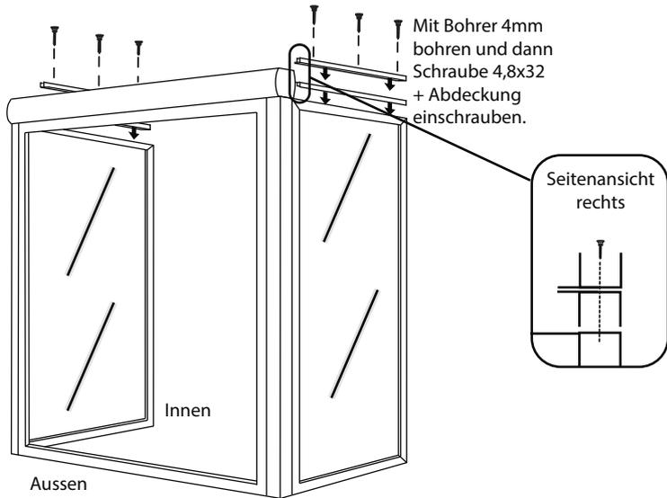
5. Messen Sie die Breite Ihrer Markise und legen Sie die Glasleisten entsprechend dieser Abmessung an die Wand. Achten Sie beim Platzieren der Glasleisten darauf, dass auf jeder Seite ein Abstand von 0,5 cm bleibt, um die Marquise richtig zu montieren. Dann schrauben Sie sie an die Wand und stellen Sie die Markise darauf.
