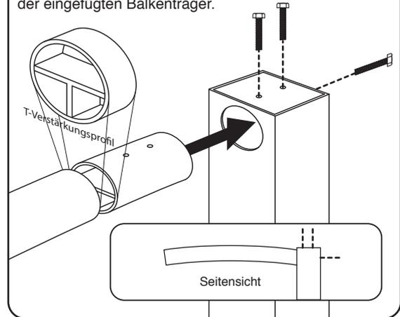
5. Die Querstäbe platzieren und mit den Schrauben befestigen (Schrauben 5,5x60).
