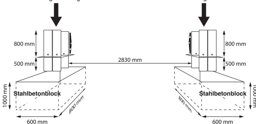
Lassen Sie die Stahlbetonblöcke von einem Fachmann, gemäß der DTU 21-Norm herstellen.
