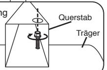
6. Die Sparren bohren und die Polycarbonatplatten anschlagend einsetzen. Die Sparren festschrauben und die Kappen mit Silikon in jedes Loch setzen. Vergewissern Sie sich, daß kein Wasser in die Löcher eindringt (Schrauben 5,5x32, Kappen 2, Silikon).
