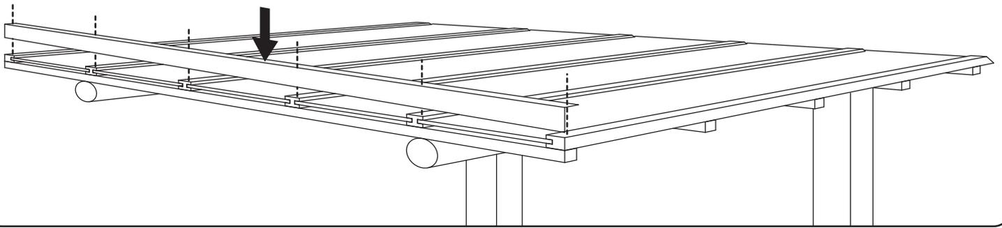
8. Anschrauben der Regenrinne mit Hilfe der T-Nut Adapter (bereits vorhanden).
